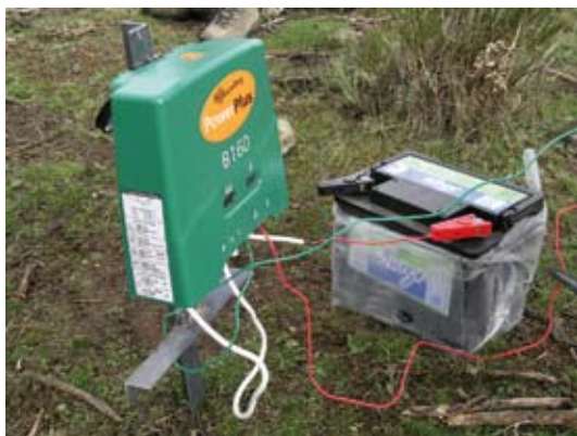
Elettrificatore alimentato da batteria d'auto
